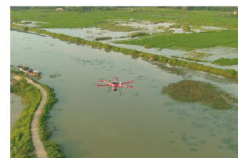
管涌渗漏巡检
